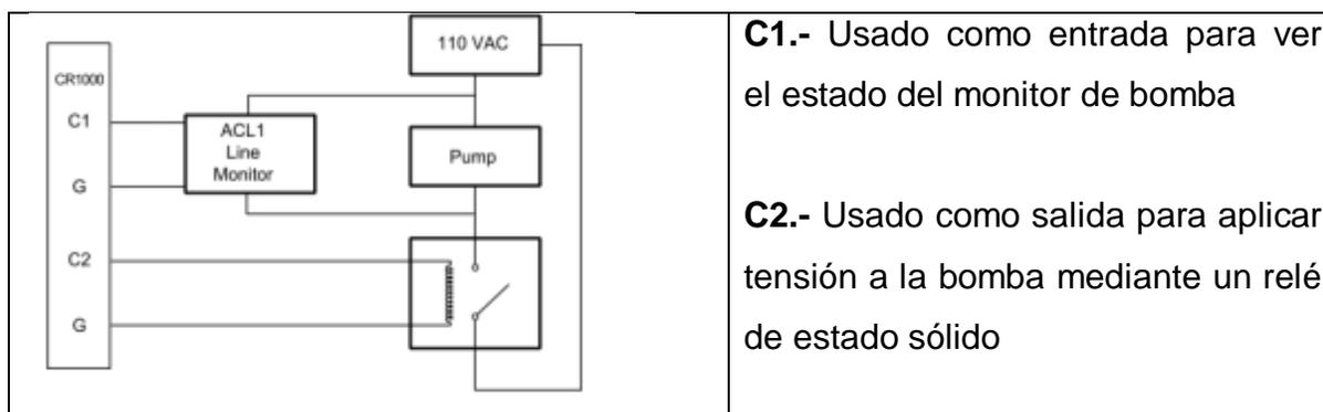
**Figura 3.3** Puertos digitales I/O usados para controlar/monitorizar bomba
