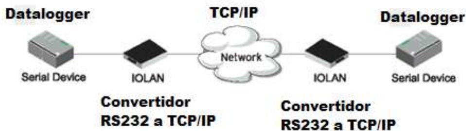
**Figura 2.2** Convertidores Túnel
