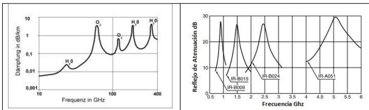
**Figura 4** Atenuación vs Frecuencia
