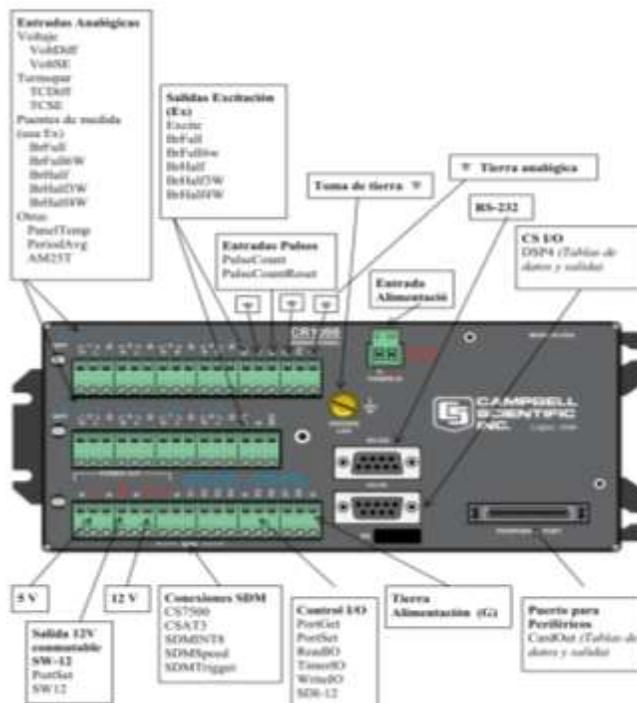
**Figura 3.2** Descripción de un Datalogger CR1000
