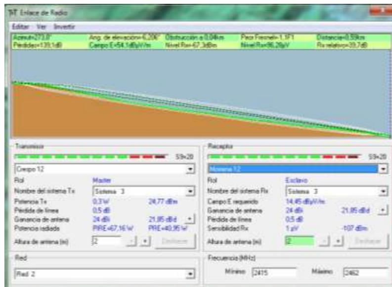
Figura 2.28 Enlace Crespo 12-Morrena 12 con antena externa
