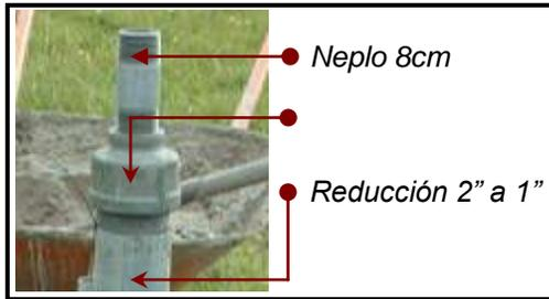
**Figura 2** Soporte para Pluviómetro con Reducción y Neplo
