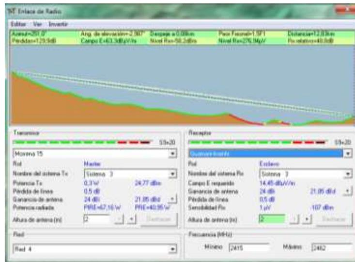
Figura 2.26 Enlace Morrena 15-Guanamá-INAMHI con antena externa
