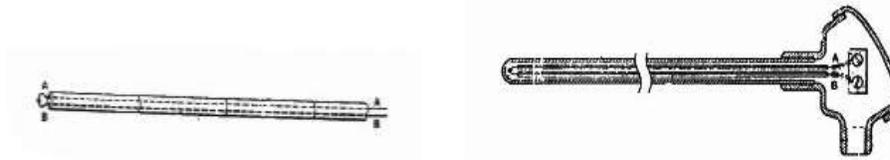
**Figura 1.24** Termocuplas para medir Temperatura del Suelo
