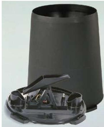
**Figura 1.16** Pluviómetro de Precipitación
