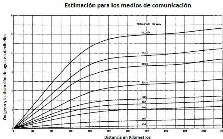
**Figura 5** Oxígeno y absorción del Agua vs. Distancia
