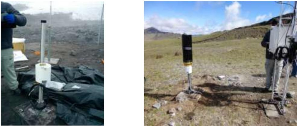
**Figura 3.15** Pluviómetro
