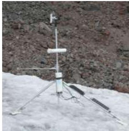
**Figura 1.27** Estación Meteorológica Móvil Samba
