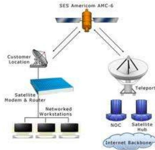
**Figura 2.18** Modelo de un transmisión VSAT
