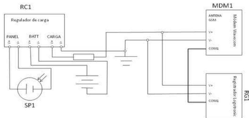
**Figura 2.17** Conexión del Modem
