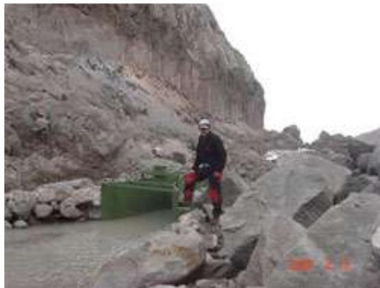
**Figura 1.9** Canaleta para medir caudal de agua
