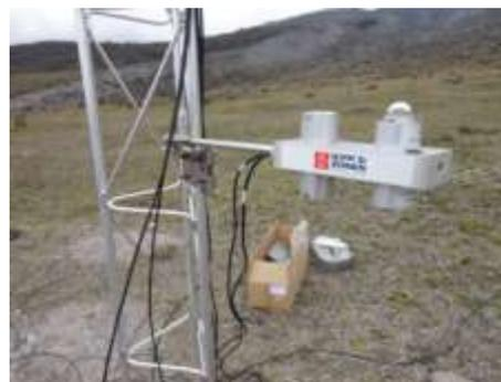
**Figura 3.12** Sensores de Radiación
