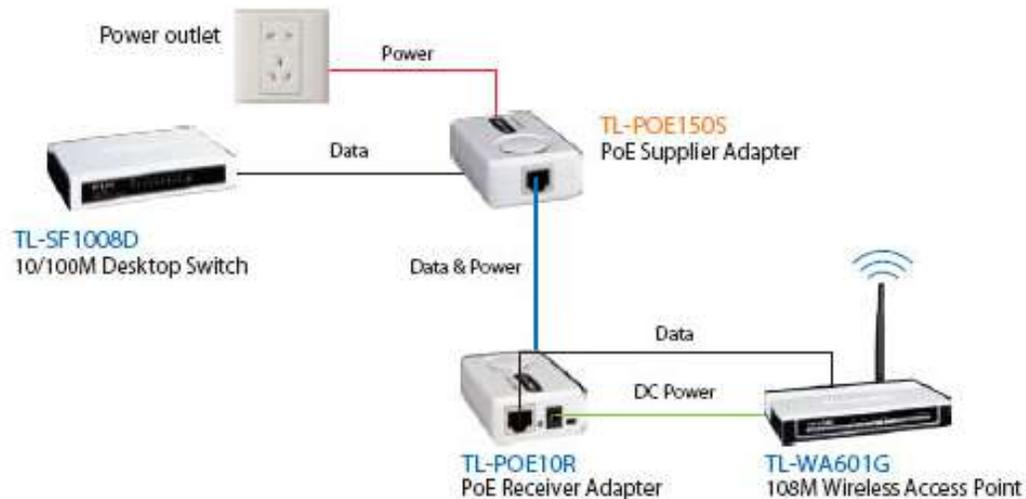
**Figura 2.10b** Segunda conexiones del POE
