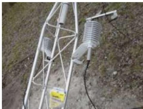
**Figura 3.9** Shell de Temperatura y Humedad Relativa
