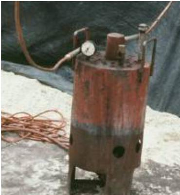
Es un elemento destinado a lograr la inmediata gasificación del BM líquido proveniente de las fuentes de liberación. Básicamente consiste en un serpentín hecho de tubo de cobre de 9.5 mm (3/8 de pulgada) de diámetro, el cual se sumerge en un recipiente con agua a temperatura de 65°C o más, la cual es calentada por una fuente de calor eléctrica o a gas. El BM líquido al pasar por serpentín caliente, se gasifica y es impulsado fuertemente hacia el recinto de fumigación.
